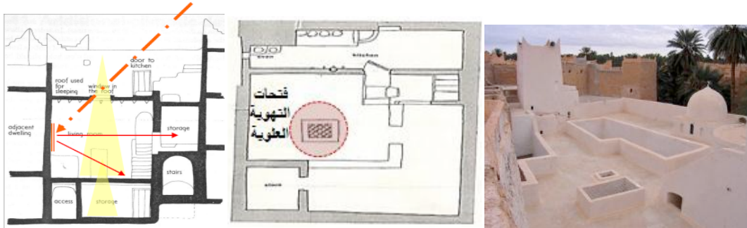
شكل رقم (5) يوضح التهوية والإضاءة الطبيعية في المساكن من خلال الفتحات السماوية.
